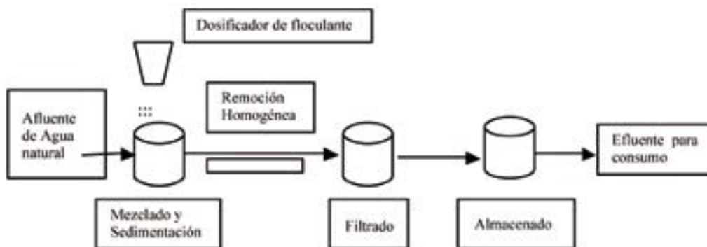
Figura 1. Diagrama de remoción de fluor en una planta de tratamiento de agua.
