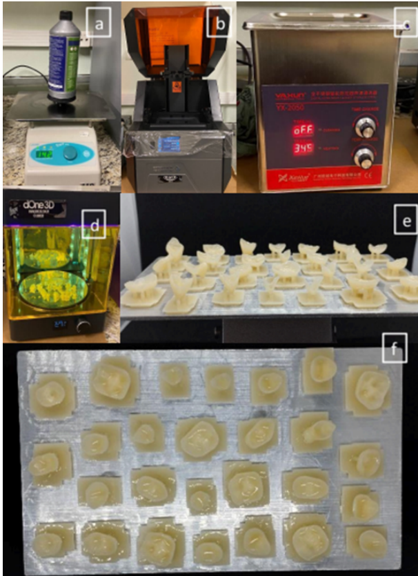
Figura 3. Processo de impressão 3D: a) Vibração para preparação da resina; b) Impressora 3D; c) Lavagem com ultrassom; d) Forno de cura; e) Coroas impressas (visão lateral dos suportes); f) Coroas impressas na base da impressora.
